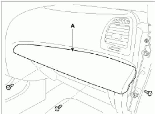
7. 拧下固定螺钉后，拆卸仪表板下盖 (A)。
