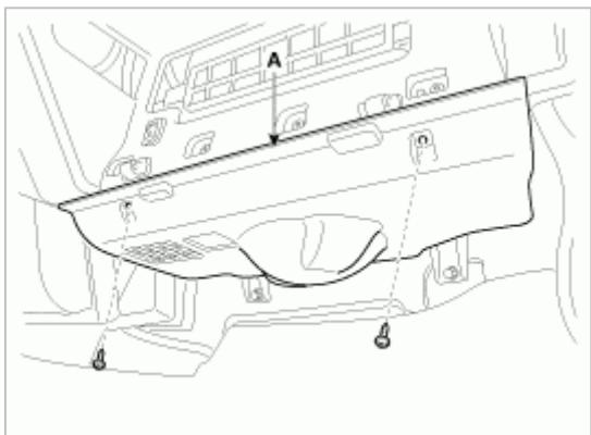
8. 拧下固定螺钉后，拆卸手套箱壳 (A)。
