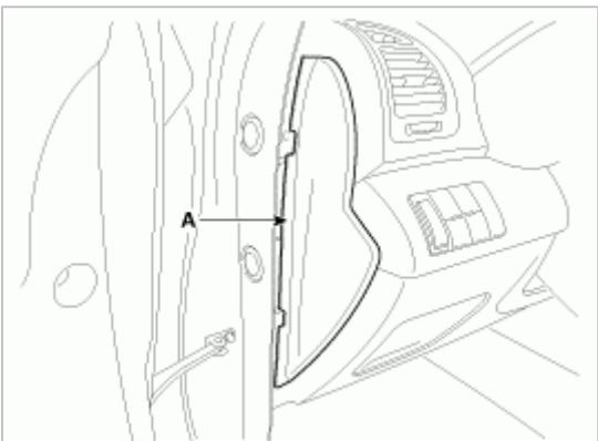
2. 拧下固定螺钉，拆卸仪表板罩下装饰板 (A)。
