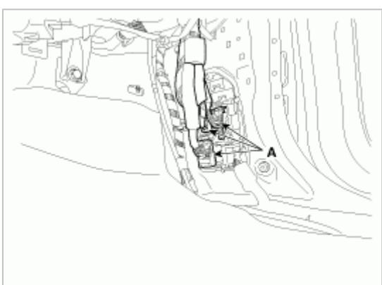
8. 分离前立柱上的连接器 (A) 和固定夹。
