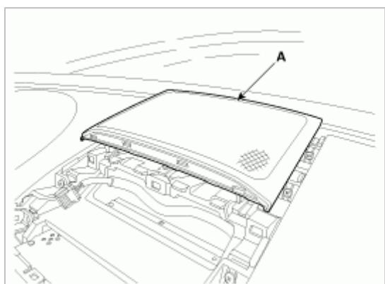
3. 拧下固定螺钉，拆卸中央扬声器总成(A)。
