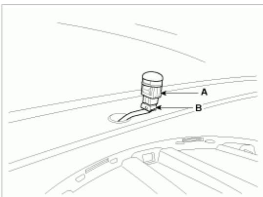
7. 使用螺丝刀或拆卸器，拆卸光强度传感器(A)。
