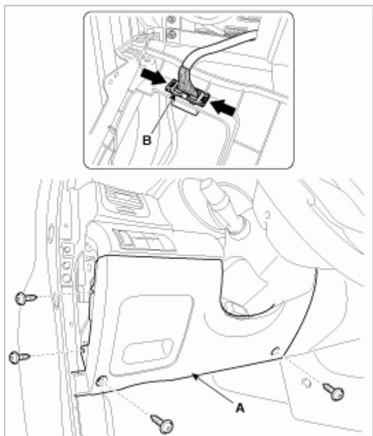
4. 拧下固定螺钉后，拆卸侧面装饰板 (A)。
