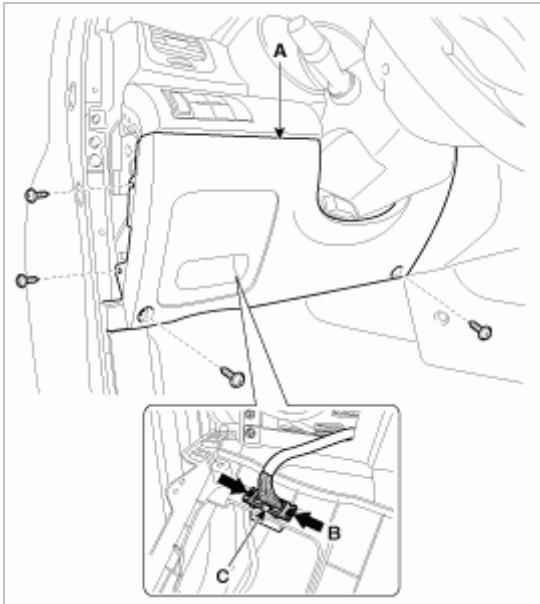
4. 拧下固定螺栓后，拆卸加固板(A)。
