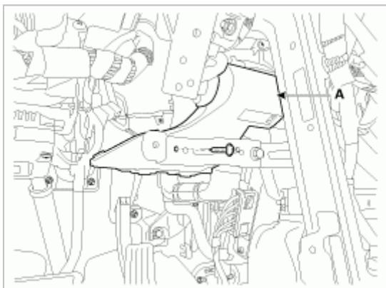
5. 分离空气囊控制模块(SRSCM)连接器(A)。
