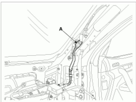
9. 拧下固定螺栓和螺母后，拆卸车颈横梁总成(A)。
