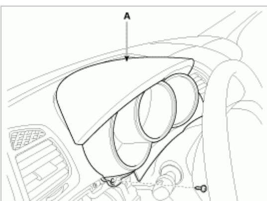
7. 拧下固定螺钉后，拆卸仪表盘 (A)。
