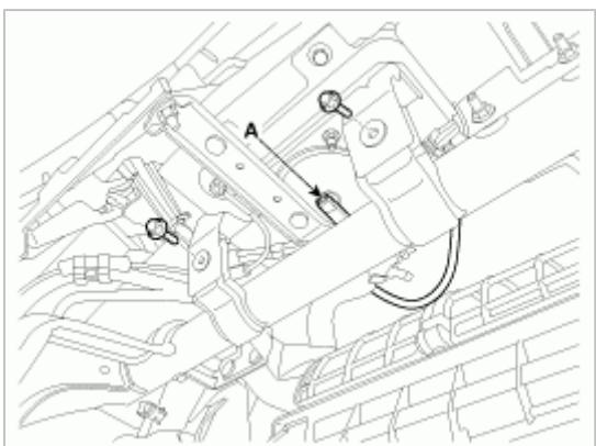
13. 拧下固定螺栓和螺母，拆卸主仪表板总成 (A)。
