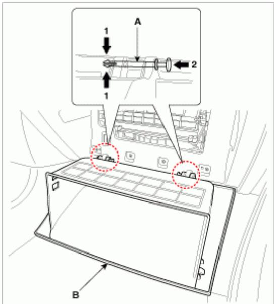
6. 拧下固定螺钉后，拆卸仪表板侧装饰 [右] (A)。
