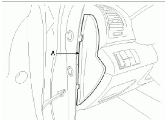
2. 拧下固定螺钉，拆卸仪表板下装饰板 (A)。
