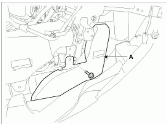
4. 拧下固定螺钉后，拆卸驾驶席网状通风管(A)。
