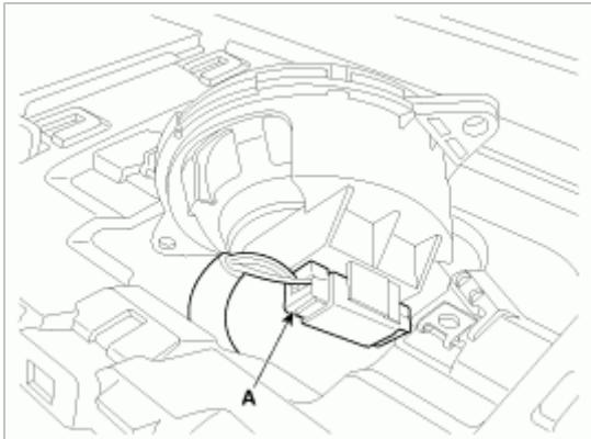
5. 使用螺丝刀或拆卸工具拆卸自动灯光传感器(A)。
