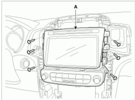
4. 分离音频/视频/导航控制模块连接器 (A)。
